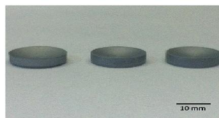
Figura 1: Catodos de tungstênio poroso usinados, retificados e decoperizados.
