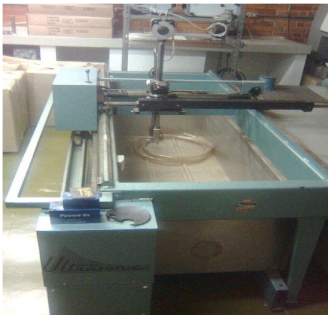
Figura 1. Equipamento para movimentação de sensores, modelo MEAUX-77, existente no LABENDE
