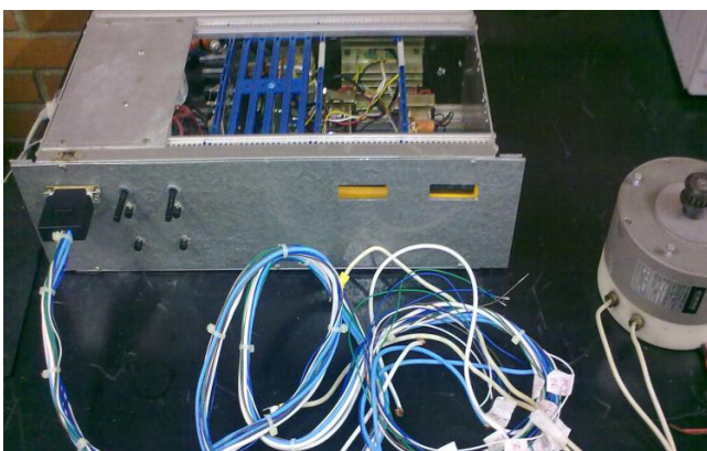
Figura 2. Aparência final dos circuitos eletrônicos montados num rack de 19”.
