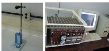
Figura 1 – Filtro de ar e espectrômetro alfa
