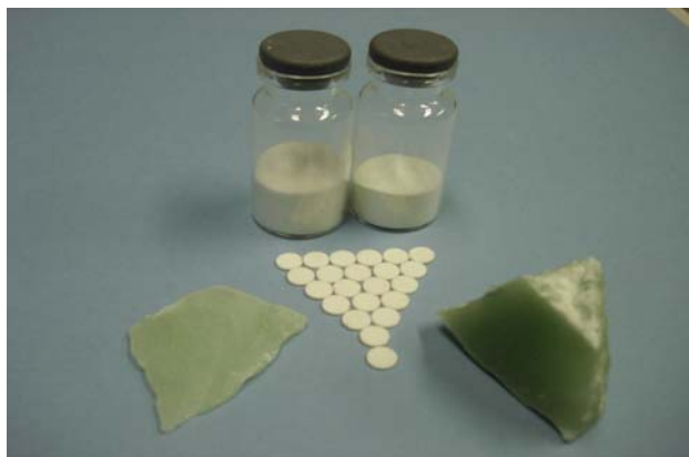
Figura 1 - Quartzo Verde apresentado em diferentes formas: pedra bruta, lâmina com 2mm de espessura, pó e pastilhas sinterizadas com Teflon®.
