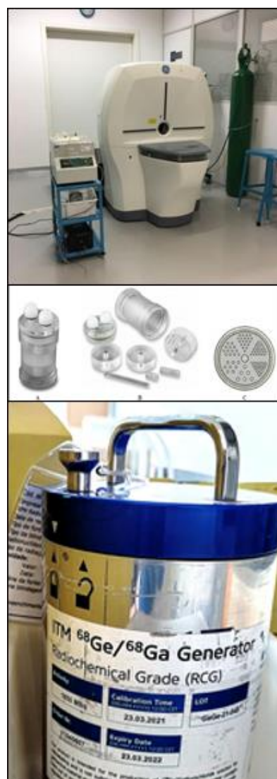
Figura 1. Superior: Tomógrafo PET do LIM/SERFA/CDTN; Meio: Simulador QMR MicroPET Hot Rod Phantom ; Inferior: Gerador ^{68}\text{Ge}-^{68}\text{Ga} ITM
