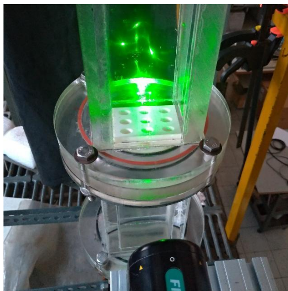
Figura 1-Seção de testes montada com o LDV acionado
