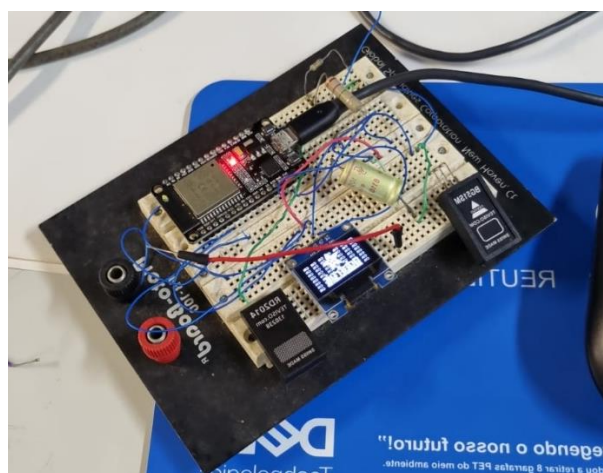
Figura 1 – Protótipo do dosímetro em desenvolvimento.
