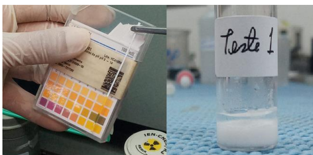
Figura 2. A esquerda temos o pH neutro obtido após a adição de 1,4 ml de HCL e na imagem a direita há a formação de precipitado e solução líquida
