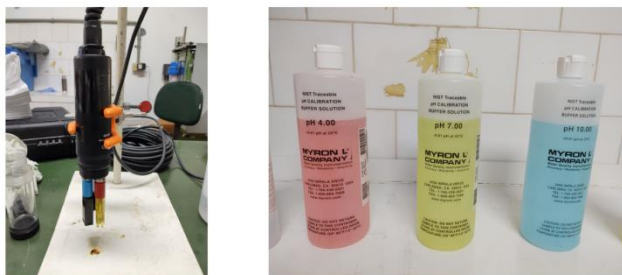
Figura 1. A esquerda, sonda multiparâmetros suspensa para limpeza e calibração; a direita, soluções para calibração do pH.
