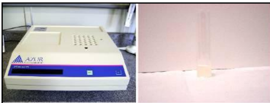
Figura 2.6 – Sistema analisador de toxicidade e cubeta de vidro (Foto: Wálace A. A. Soares)
