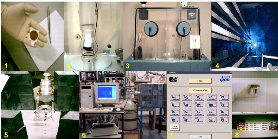
**Figura 10** – Etapas do procedimento experimental: 1) Preparo da amostra em papel utilizando 100  $\mu$ L de sangue total; 2) Invólucro de irradiação onde a amostra biológica é acondicionada; 3) Estação pneumática de irradiação; 4) Reator de pesquisa IEA - R1; 5) Detector de germânio hiperpuro; 6) Instrumentação Nuclear; 7) Software Ativação; 8) Acondicionamento das amostras biológicas após irradiação.
