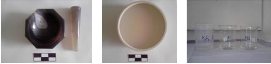
FIGURA 11 – Etapas de preparação da amostra para obtenção do quartzo.
