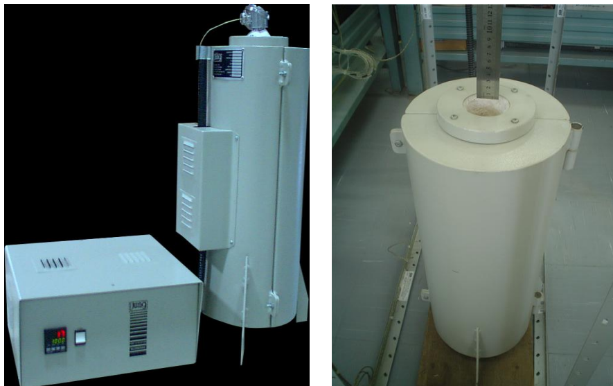
Figura 11: Forno vertical utilizado na técnica de Bridgman.
