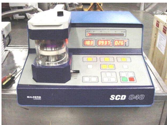
Figura 16: Evaporadora utilizada para evaporar um filamento de carbono na superfície do cristal para torná-lo condutivo.
