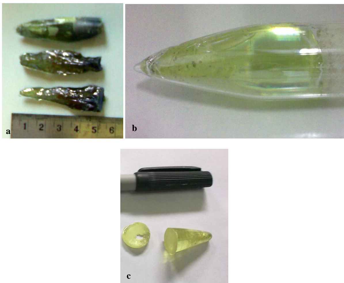
Figura 23: Cristais de TlBr crescidos pelo método de Bridgman a partir do sal 2: (a) submetido a um crescimento, (b) submetido a dois crescimentos e (c) submetido a três crescimentos.
