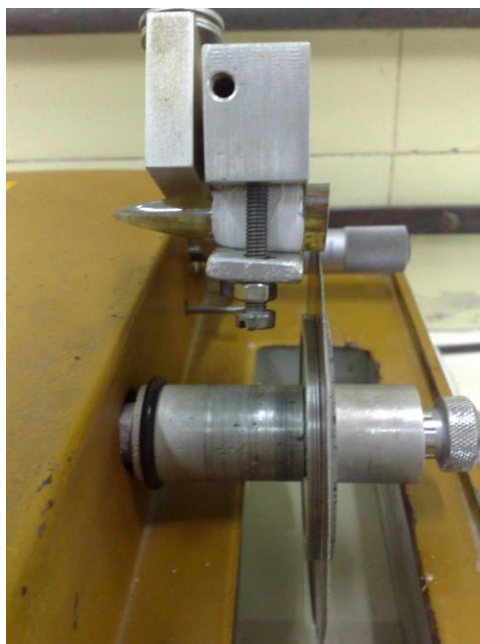
Figura 14: Corte do cristal de TlBr com serra de diamante.
