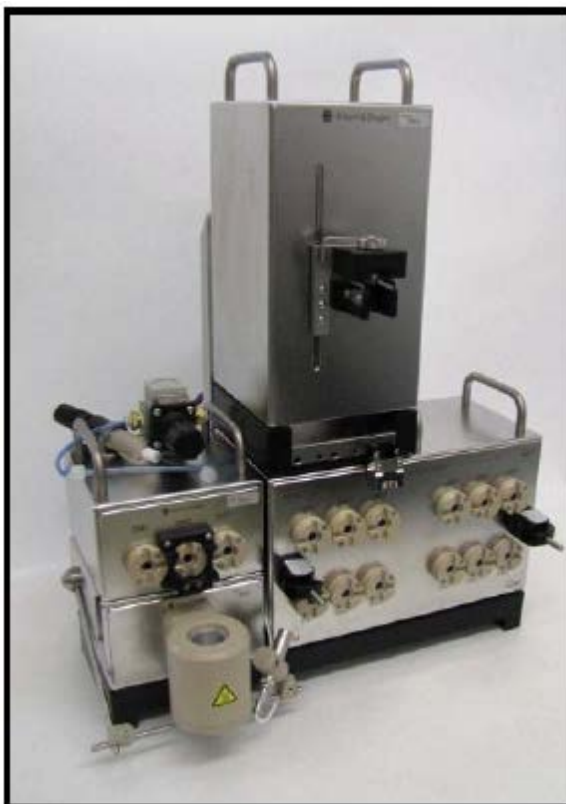
Fig. 09 – Módulo automático Modular – Lab Pharm Tracer utilizado para marcação automatizada dos derivados de bombesina DOTA conjugados com ^{68}\text{Ga}
