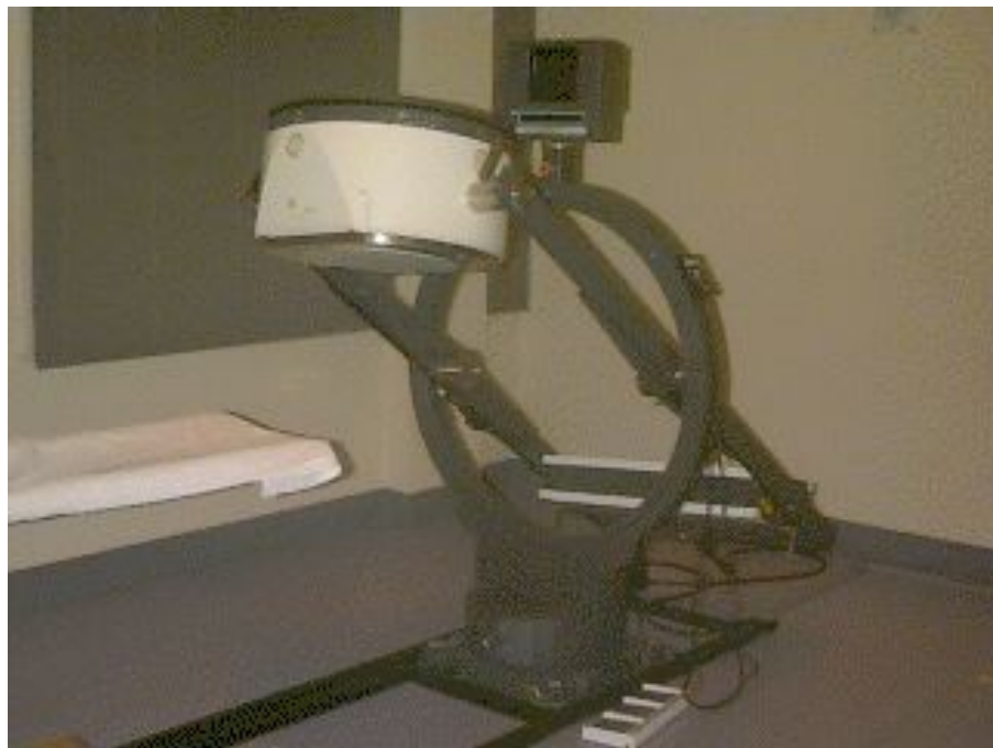
FIGURA 01 – Câmara de Cintilação (Gama câmara) de uma cabeça, um dos primeiros equipamentos utilizados em Medicina Nuclear. (Gama Camara, 2014).
