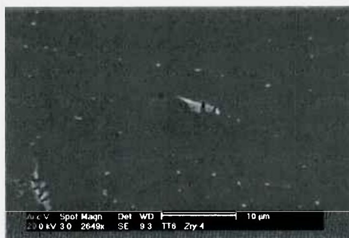
Figura 39: Micrografias MEV mostrando precipitados na amostra TT6.
