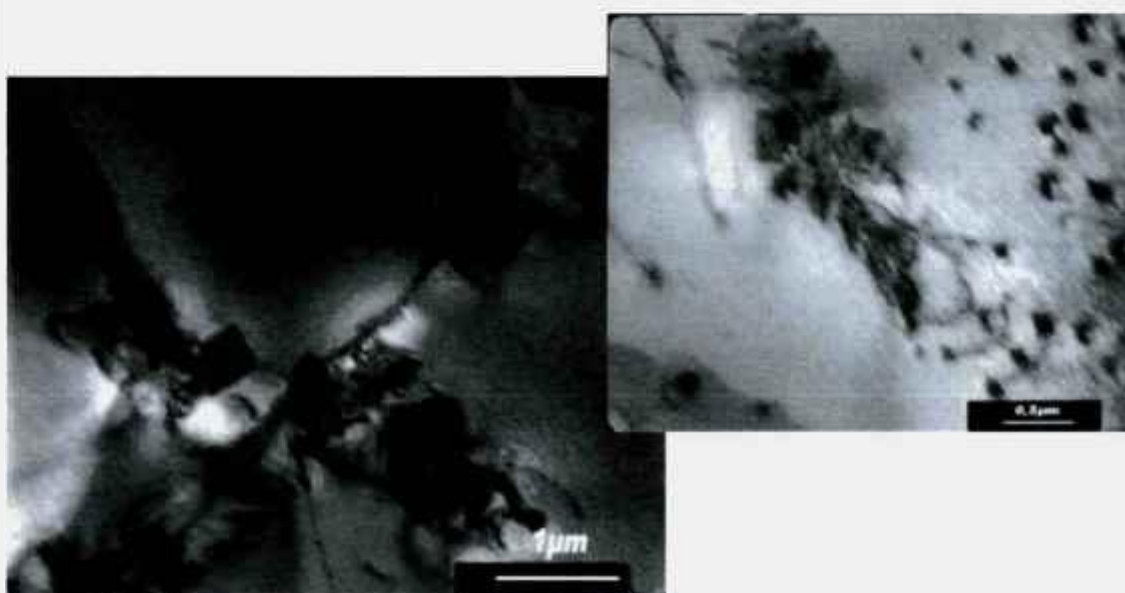
Figura 28: Micrografias MET da amostra TT3, onde podem ser observados alguns precipitados.
