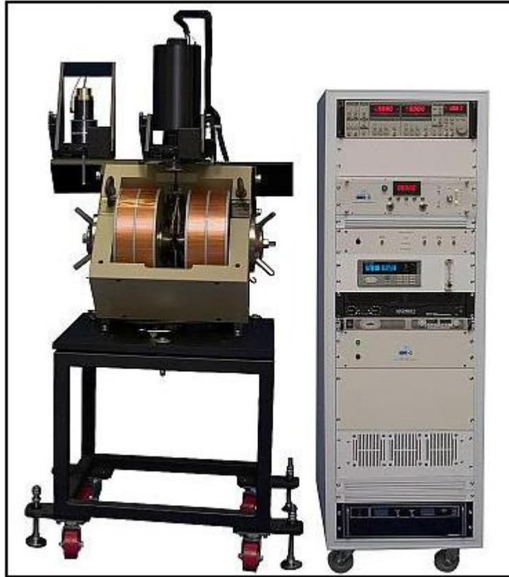
*Figura 8 – Magnetômetro de amostra vibrante*
