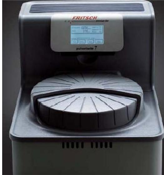
**Figura 6** – Moinho de alta energia/velocidade (Fritsch, modelo P7)
