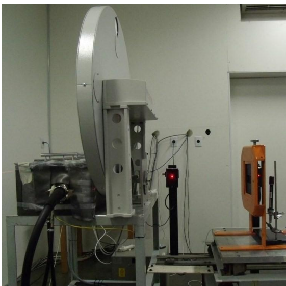
Figura 18. Posicionamento da câmara RC6 para calibração do PDC.
