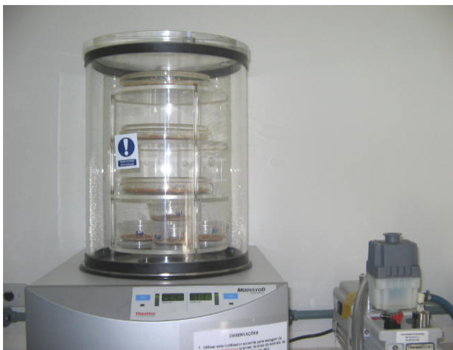
Figura 23 - Foto da liofilização das amostras – Liofilizador Thermo Electron Corporation, modelo Modulyo D-115
