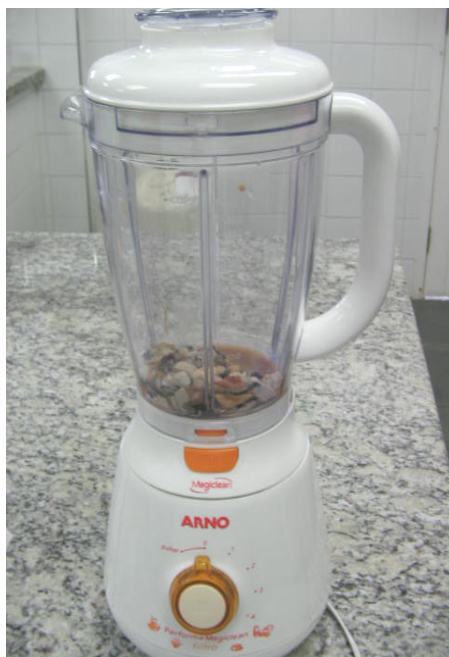
Figura 21 - Fotos da homogeneização em liquidificador com facas de titânio
