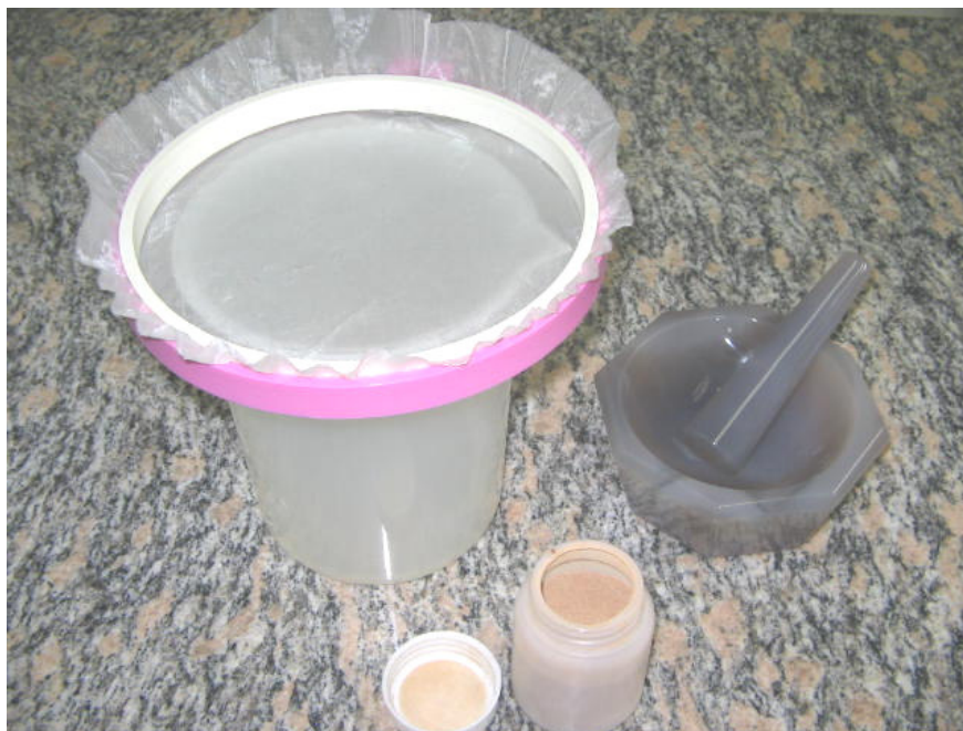
Figura 24 - Foto da etapa de moagem das amostras de mexilhões, após a liofilização
