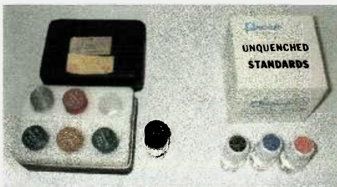
FIGURA 4.5 - Vials contendo os seis padrões com agentes de quenching e o padrão sem quenching da Packard, utilizados na curva de eficiência para determinação de trício.
