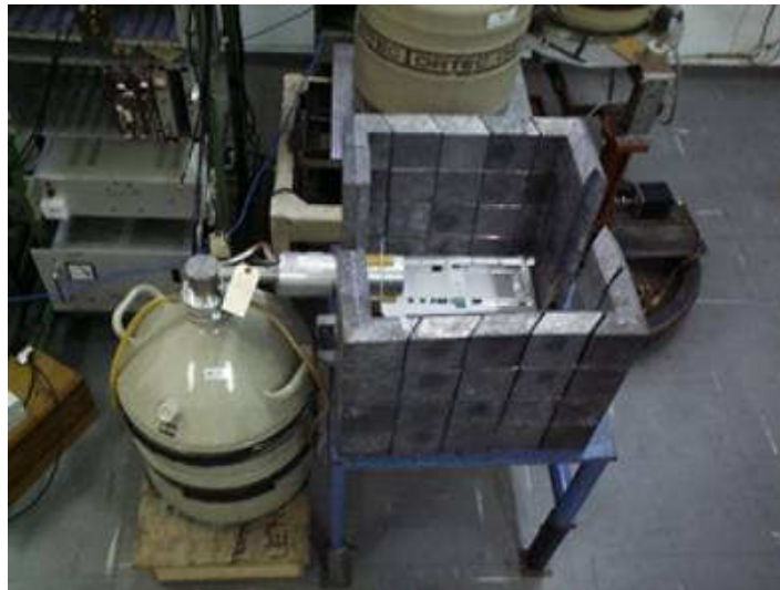
FIGURA 2 - Vista superior do detector HPGE de 198\text{cm}^3 (FWHM = 1,87\text{keV} ).
