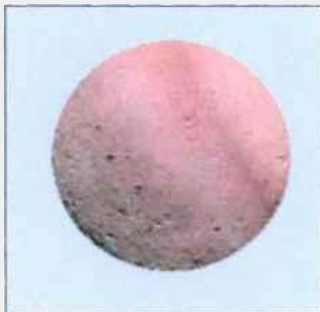
FIGURA 21. Detalhe da mancha ocorrida nos corpos de prova, na forma esferoidal, queimados a 900 °C, para concentrações de 30, 40 e 50 % de resíduo de PRFV.
