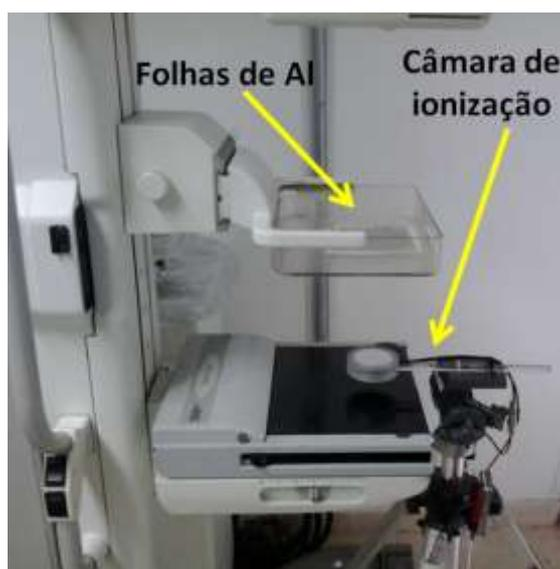
Figura 4.54. Arranjo experimental para determinação da camada semirredutora com as folhas de alumínio e a câmara de ionização posicionadas no mamógrafo convencional GE Senograph DMR *plus*
