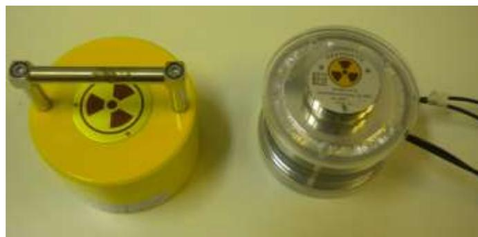
Figura 4.47. Fonte de  $^{90}\text{Sr}+^{90}\text{Y}$  posicionada sobre uma das faces do Protótipo 1 com o uso do suporte de acrílico desenvolvido
