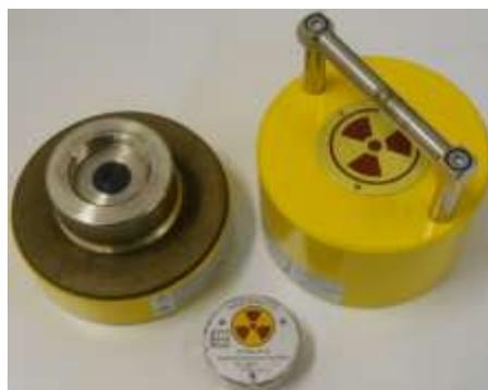
Figura 3.3. Fonte de controle de  $^{90}\text{Sr}+^{90}\text{Y}$  utilizada para verificar a estabilidade da resposta das câmaras de ionização
