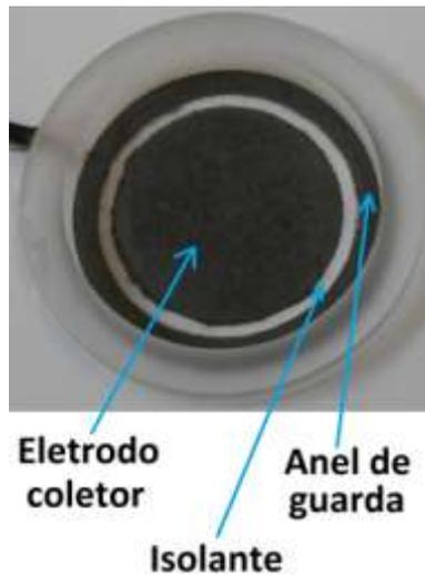
Figura 4.4. Eletrodo coletor, isolante e anel de guarda do Protótipo 3
