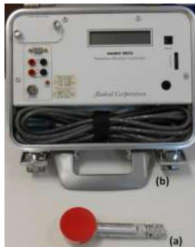
Figura 3.7. Câmara Radcal 10X5-6M e o eletrômetro Radcal 9015
