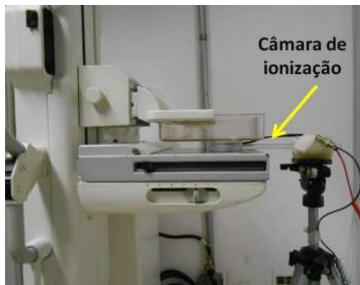
Figura 4.53. Arranjo experimental para obtenção do kerma incidente substituindo o objeto simulador pela câmara de ionização posicionada no mamógrafo convencional GE Senograph DMR *plus*
