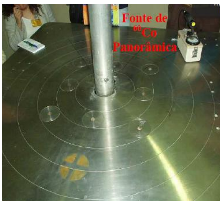
FIGURA 23 - Irradiador do tipo panorâmico da marca Yoshizawa Kiko ® , modelo FIS 60-04, de radiação de ^{60}\text{Co} , do CTR/IPEN.
