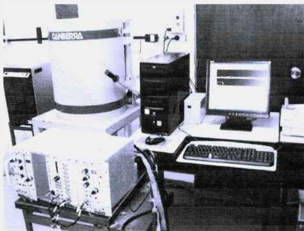
FIGURA 5: Detector de germânio hiperpuro Canberra modelo 747.
