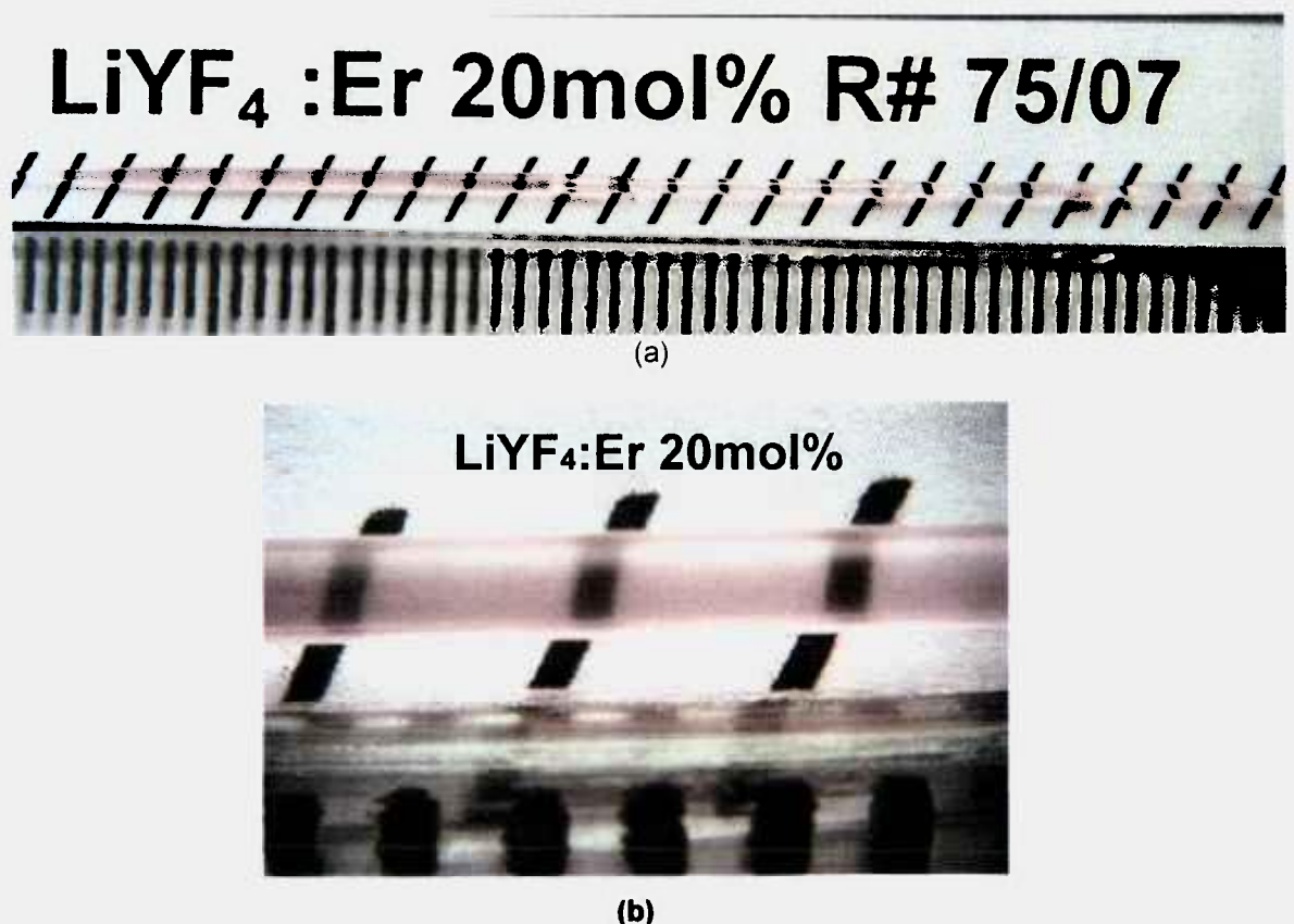
Figura 17: (a) Fibra de YLF: Er 20mol% com diâmetro variável. (b) Detalhe de (a) apresentando diâmetro constante.
