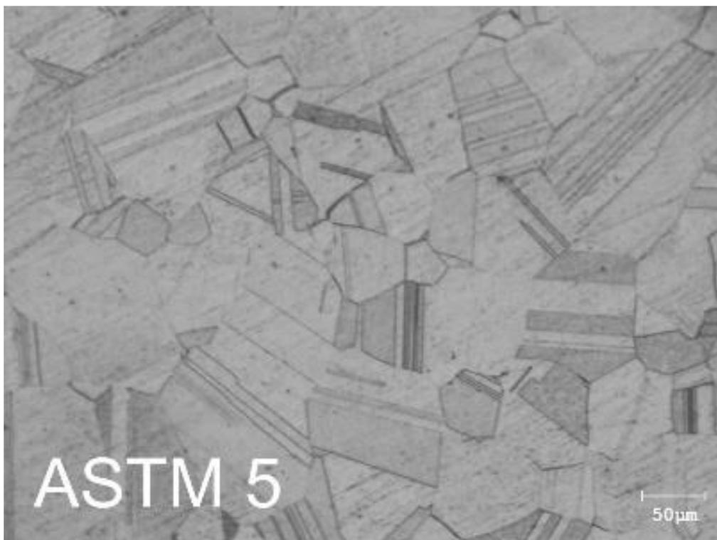
*Figura 48 - Metalografia CoCr tratado a 1250°C por 7 minutos*
