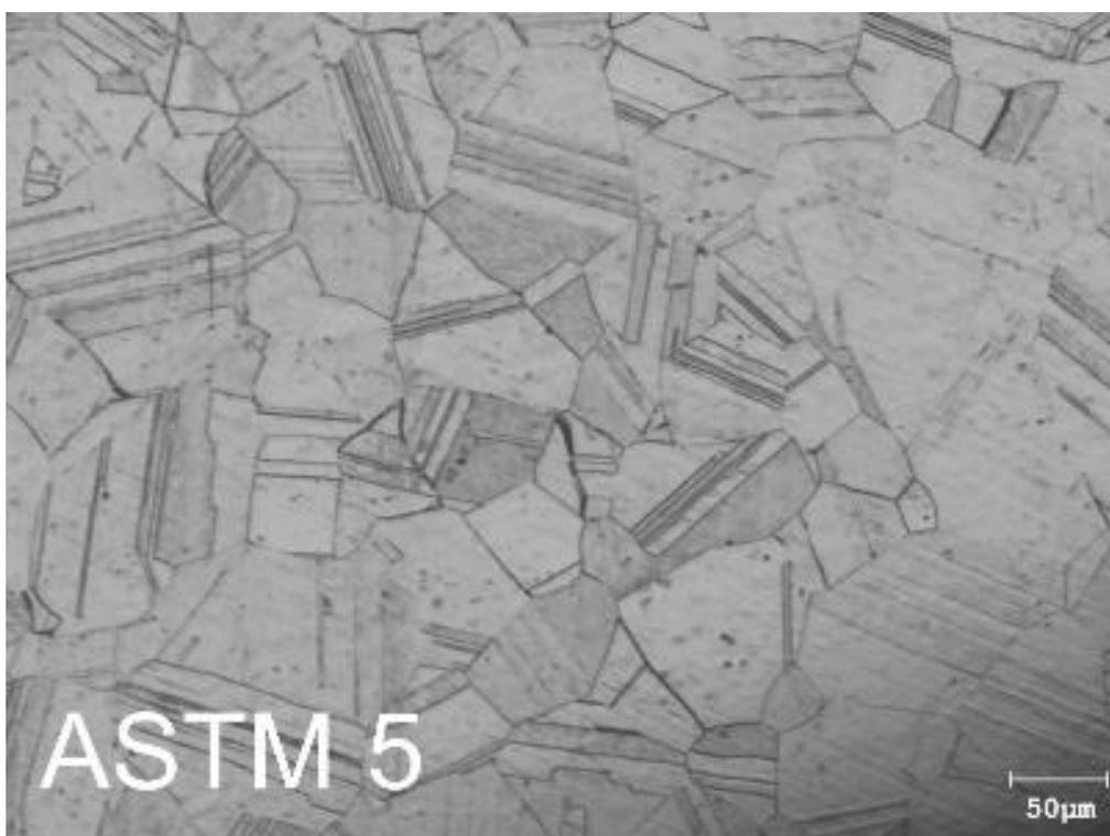
*Figura 47 - Metalografia CoCr tratado a 1250°C por 4 minutos*
