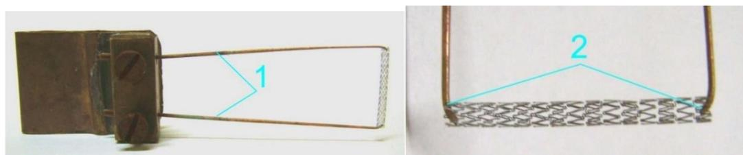
*Figura 8 - 1 Detalhe do dispositivo que posiciona o stent para o eletropolimento. 2. Detalhe do Stent posicionado no suporte*
