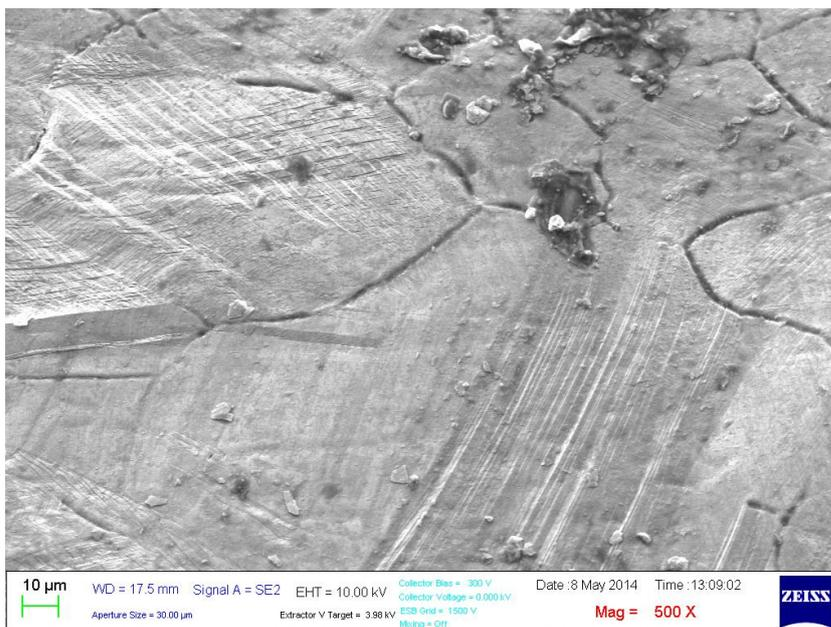
*Figura 37 - Imagem de amostra tratada à 1250°C por 15 minutos após ensaio de tração in situ.*
