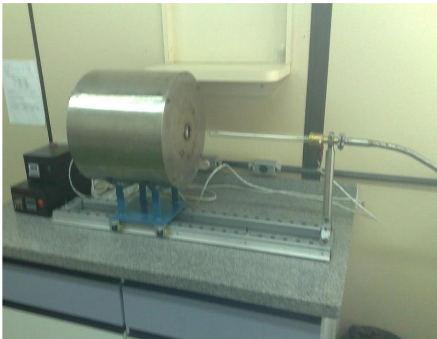
*Figura 7 - Forno para tratamento térmico dos stents produzidos e que passam por nova decapagem antes de serem eletropolidos.*
