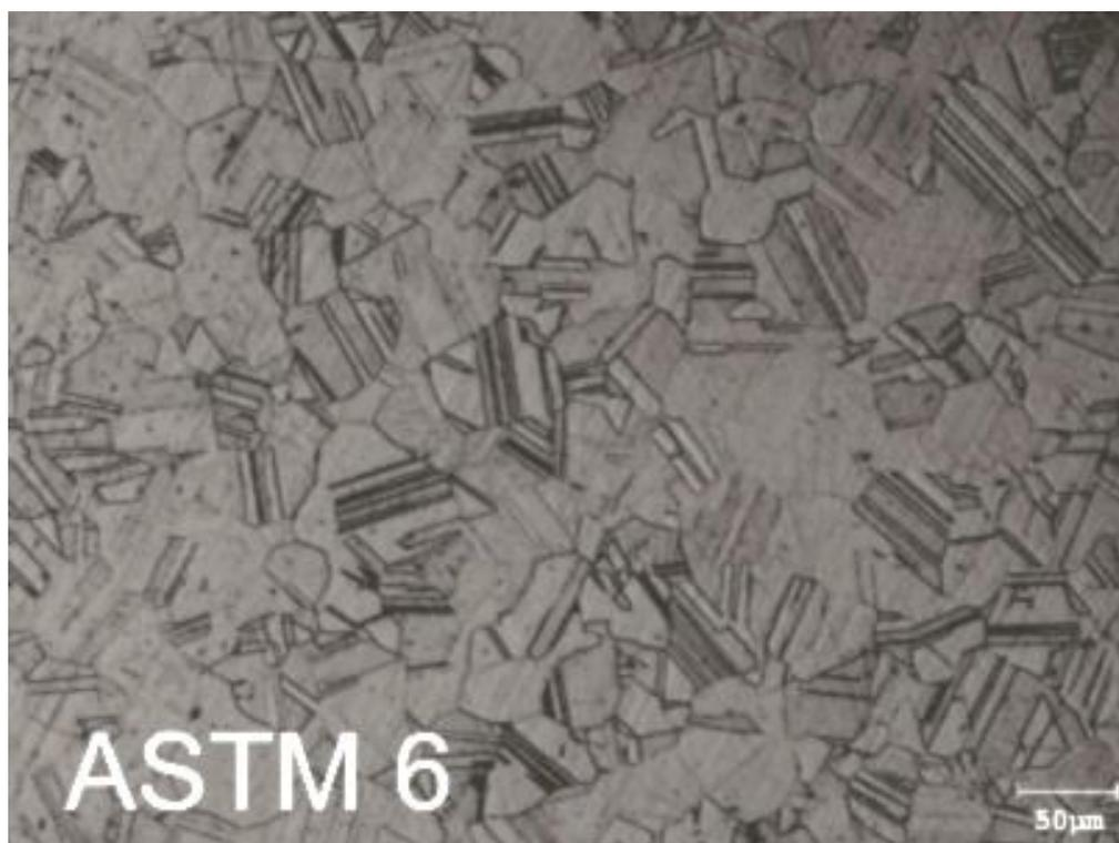
*Figura 43 - Metalografia CoCr tratado a 1175°C por 4 minutos*
