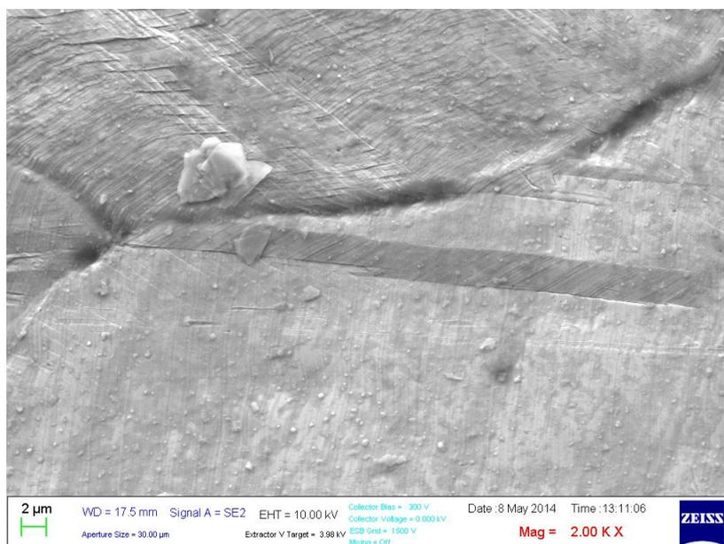
*Figura 38 - Imagem de amostra tratada à 1250°C por 15 minutos após ensaio de tração in situ.*
