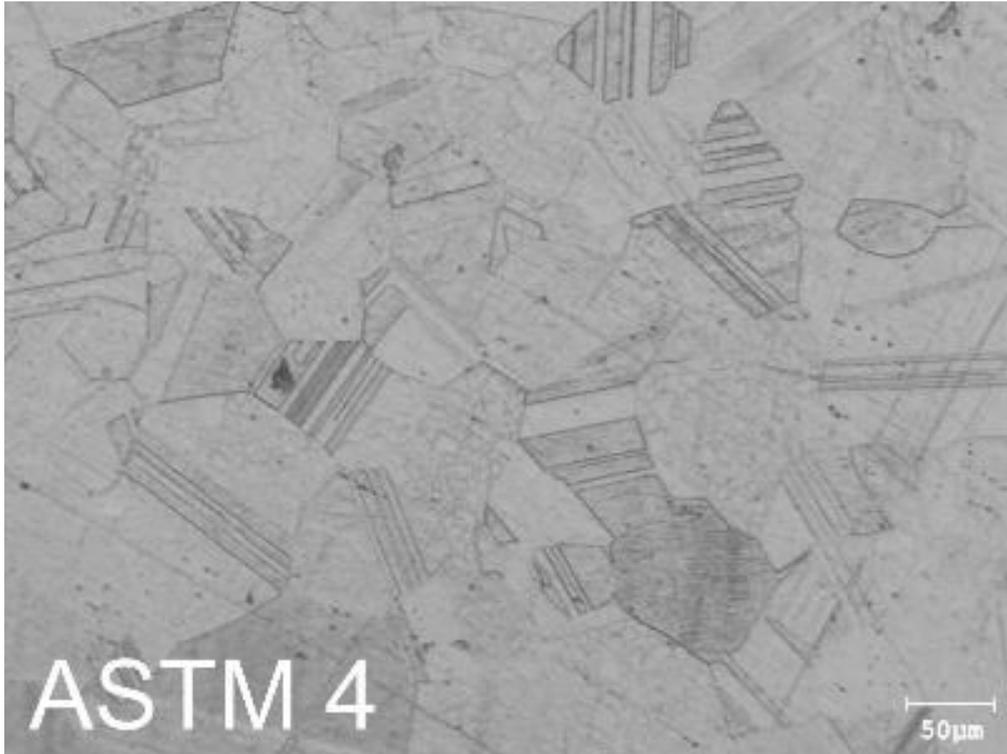
*Figura 50 - Metalografia CoCr tratado a 1250°C por 15 minutos*
