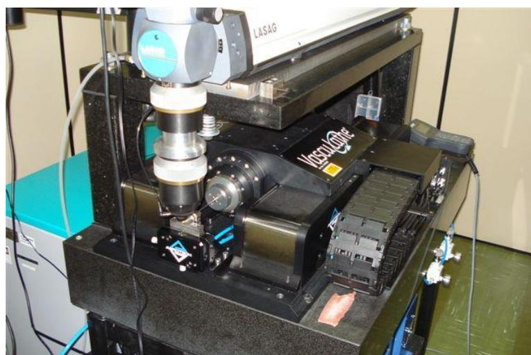
*Figura 6 - Sistema de corte a laser: Detalhe do sistema laser na parte superior e o CNC na parte inferior.*
