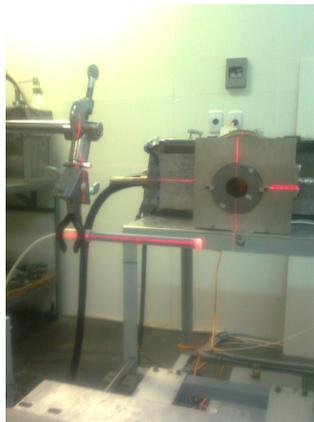
Figura 30. Arranjo dosimétrico para determinação das taxas de Kerma no ar, com a câmara de ionização tipo lápis posicionada a 100 cm.
