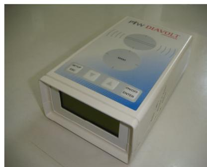
FIGURA 21: Medidor não-invasivo de tensão (PPV), marca PTW, modelo Diavolt, Alemanha.
