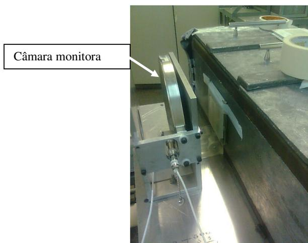
Figura 20: Câmara monitora posicionada na saída do tubo de raios X.
