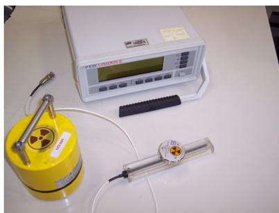
Figura 23: Câmara de ionização tipo lápis acoplada ao eletrômetro UNIDOS-E e com a fonte de controle posicionada.
