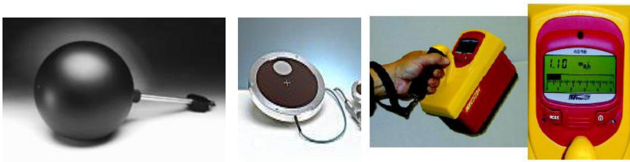
Figura 13: Modelos de câmaras de ionização.
