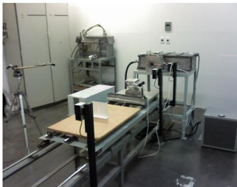
Figura 18. Sistema de raios X marca Pantak/Seifert, modelo do tubo MXR-160/22 na faixa de operação de radiodiagnóstico clínico 40-160 kV.
