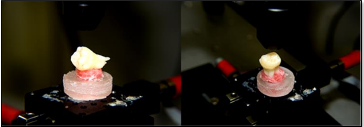
Figura 6 - Imagem das amostras no sistema translador XY do OCT OCP930SR, da Thorlabs, EU.
