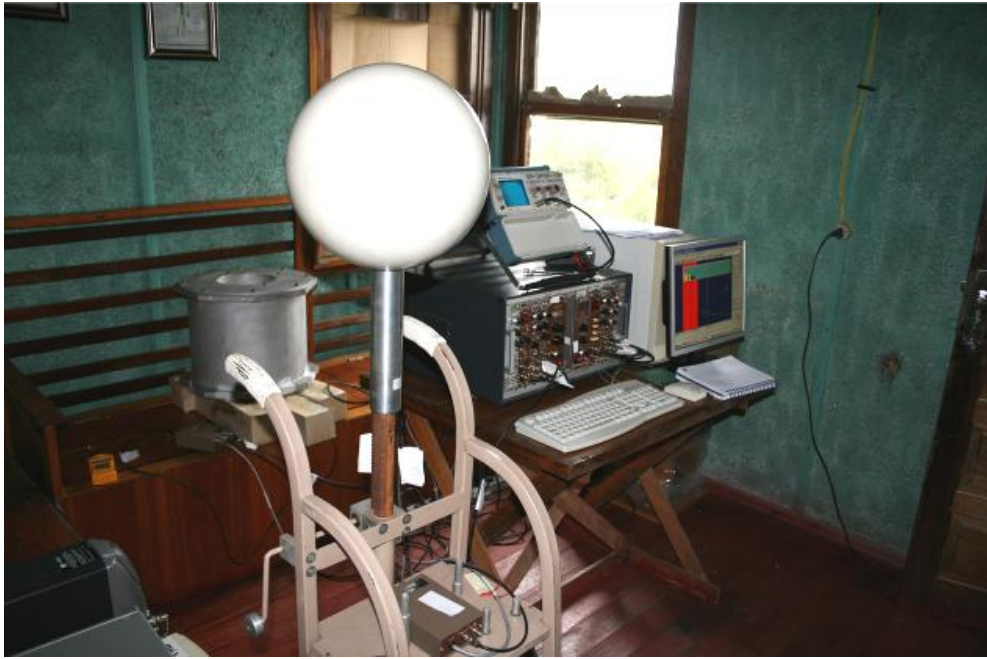
Figura 39 - Arranjo montado no Parque Nacional do Itatiaia - PNI (2.400 m), para medição do espectro e fluxo de nêutrons.
