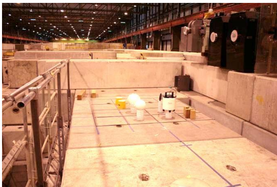
Figura 55 - Parte dos equipamentos, em irradiação sobre a plataforma de concreto.
