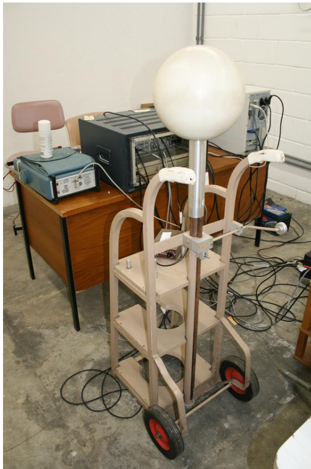
Figura 40 - Arranjo montado no Laboratório de Caracterização de Monitores de Radiação do IEAv (680 m), para medição do espectro e fluxo de nêutrons.
