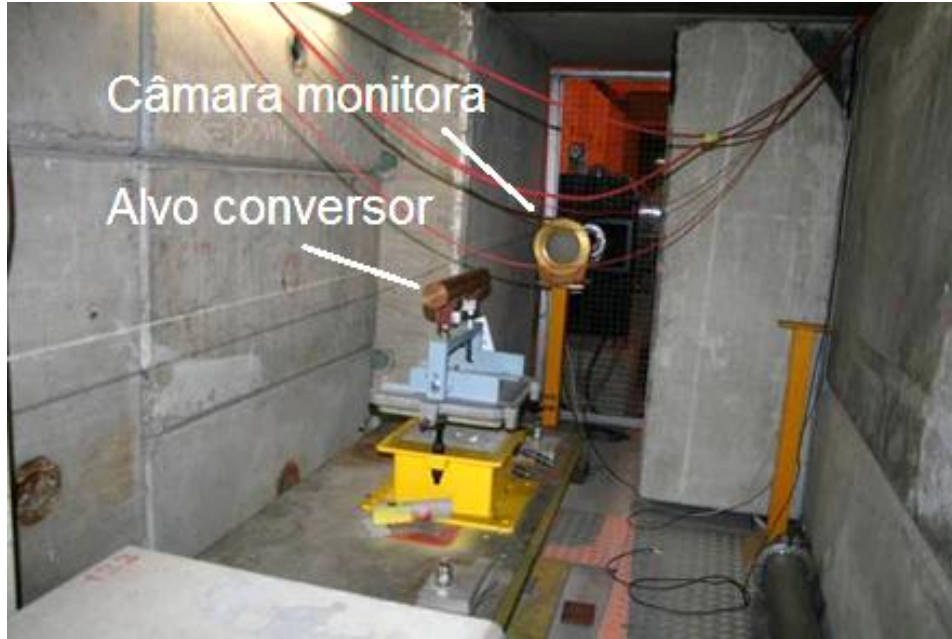
Figura 50 - Sala de alvos, onde se pode observar a câmara monitora, posicionada na saída do feixe de hádrons, e o alvo conversor, constituído de cobre.
