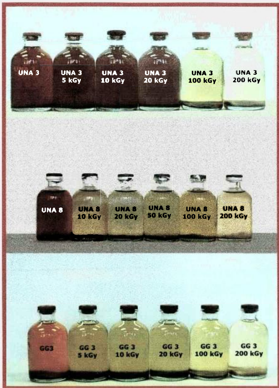
FIGURA 31 - Descoloração das amostras UNA (A3 e A8) e GG (A3), após irradiação com feixe de elétrons em diferentes doses
