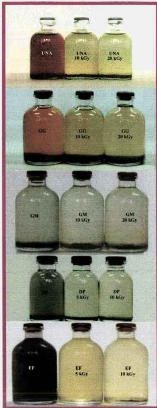
FIGURA 30 - Fotos das amostras com maior coloração dos 5 pontos de coleta da ETE-Suzano, brutas e irradiadas com feixe de elétrons
