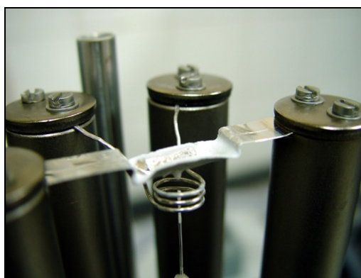
Figura 4.16 - Fotografia do cadinho após processo de fusão e máximo puxamento do material de partida (YLF estequiométrico com 2 mol% de excesso de LiF). A câmara de crescimento recebeu tratamento prévio e os procedimentos de fusão e puxamento foram efetuados sob fluxo de argônio tratado.
