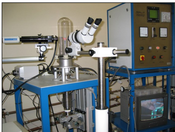
Figura 3.4 – Apresentação final do sistema de \mu -PD comercial adaptado para o puxamento de fibras de fluoretos.
