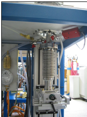
Figura 3.3 - Fotografia da adaptação do sistema de vácuo à câmara de crescimento do equipamento de \mu -PD comercial de puxamento de fibras.
