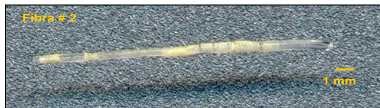
Figura 4.3 - Fotografia da segunda fibra de LiF obtida no protótipo do sistema de \mu -PD construído no IPEN após o ajuste do sistema eletrônico de corrente.
