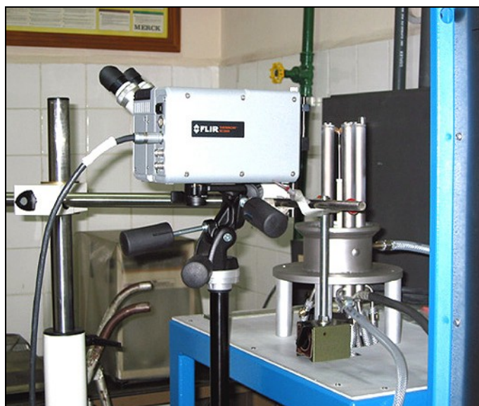
Figura 3.5 – Arranjo experimental para a medida do gradiente de temperatura nas vizinhanças do capilar durante o processo de crescimento em estado estacionário de uma fibra de LiF em um cadinho de platina.
