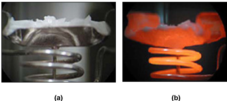
Figura 4.15 - : Processo de aquecimento para o crescimento da fibra de LLF: (a) cadinho e carga inicial antes da fusão e (b) cadinho e carga após a fusão: formação da solução sólida.
